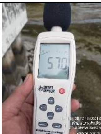
รูปที่ ๕-๗ ตรวจสอบระดับเสียง เก็บข้อมูลในงานที่ก่อให้เกิดเสียงดัง (งานสกัดคอนกรีต)
